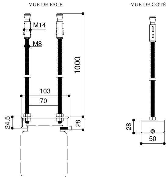
Le SLOPING CEILING support pour le Screen Winch System à été développé pour monter le carter d'écran sur un mur ou un plafond en pente. Le support peut être incliné à n'importe quel angle pour être adapté à la pente du plafond. Si le support est incliné à 90°, il peut être utilisé pour un montage mural.
