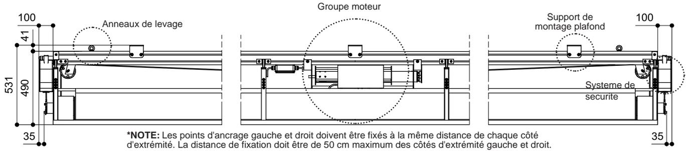
\*NOTE: Les points d'ancrage gauche et droit doivent être fixés à la même distance de chaque côté d'extrémité. La distance de fixation doit être de 50 cm maximum des côtés d'extrémité gauche et droit.
